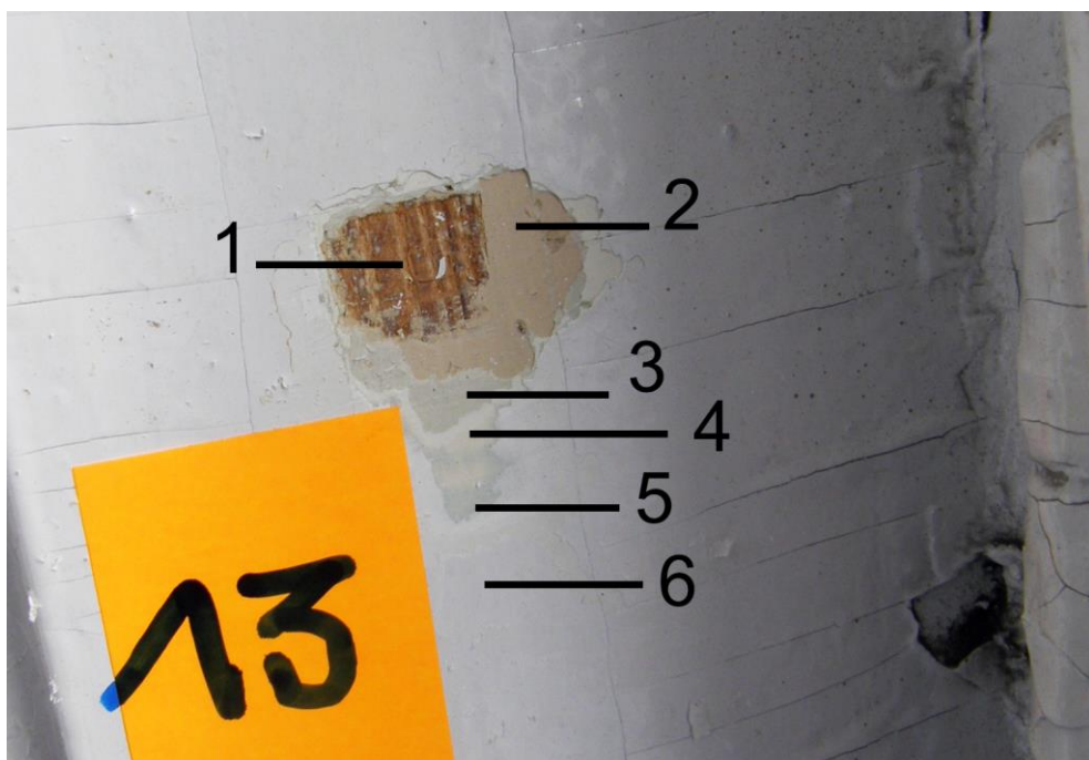
Fot.42 Odkrywka nr.13 Historyczne okno drewniane /futryna / na parterze w sali nr. 8. Widoczne warstwy; 1- ciemno brązowa NCS S 6030-Y30R , 2-jasna beżowa, 3-szara, 4-jasna kremowa, 5-jasno niebieska, 6-biała
